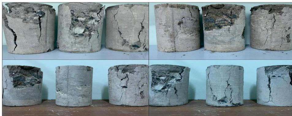
**Gambar 8.** Gambar setelah uji tekan beton
