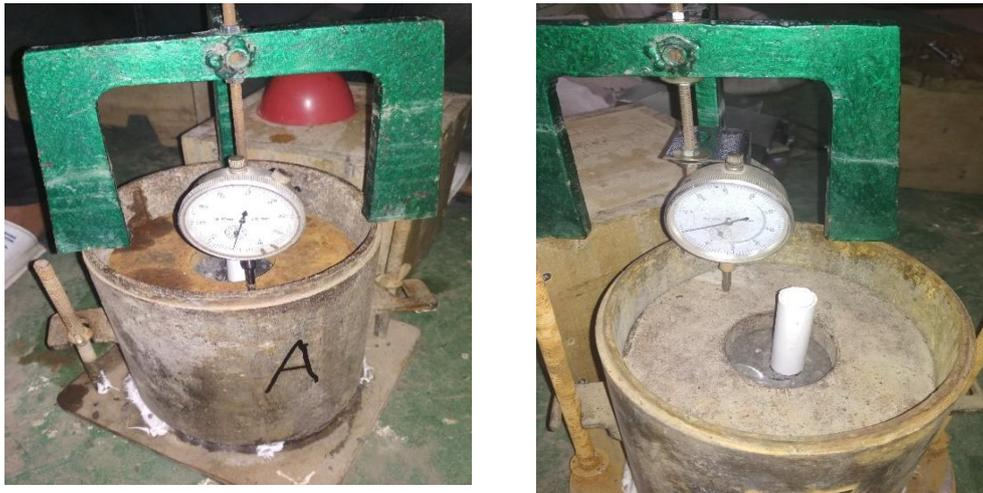
**Gambar 3.** Pengujian pengembangan tanah ekspansif
