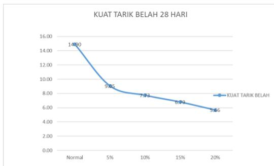
**Gambar 9.** Grafik Pengujian Kuat Tarik Belah Beton
