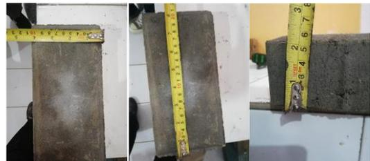
**Gambar 4.** Hasil uji Pengukuran Ketebalan Bata Beton
